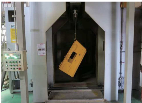
図3 乾燥炉から出るワーク（二重扉となっており炉内の熱風流出や異物混入を防いでいる）
